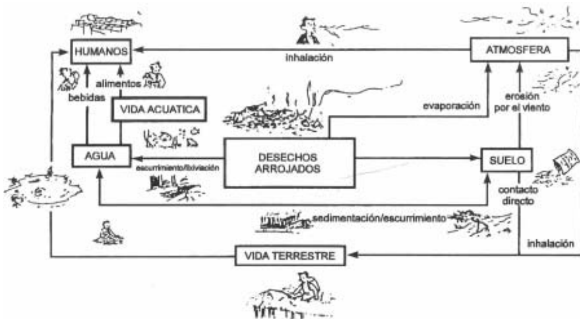
Figura II.1: Vías de exposición a peligros generados por la basura arrojadas
