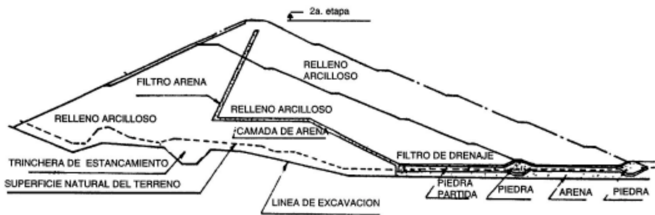
Figura 5 - Sección típica de represa de tierra
