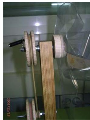
**Detalle del mecanismo amplificador**
