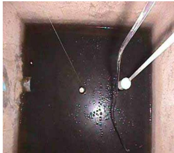
Figura 10. Foso Limnimétrico.
