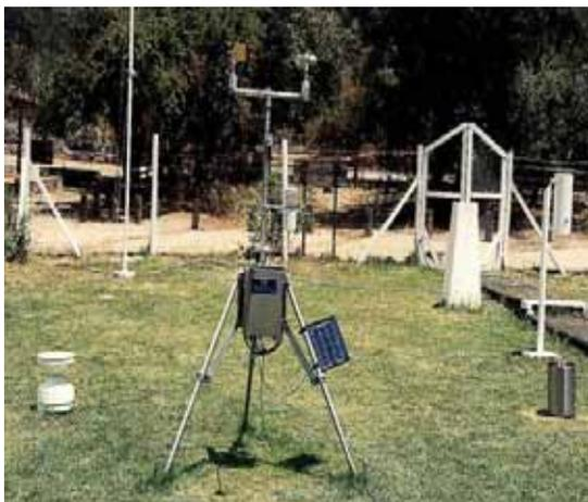
Figura 5. Estación Meteorológica automática.
