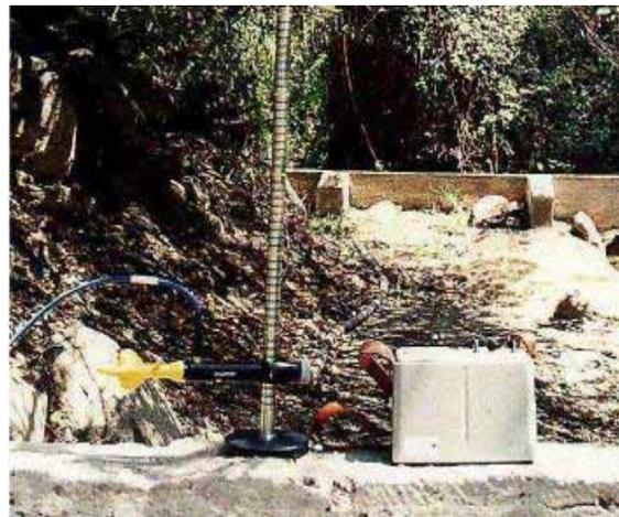
Figura 12. Medidor de velocidad de flujo o correntómetro.
