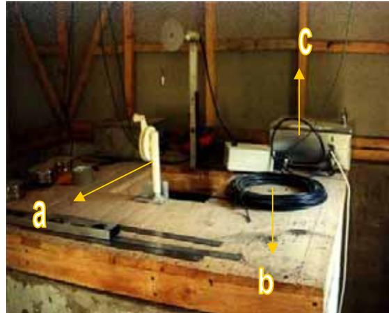
Figura 9. (a) Dipflash, (b) presurómetro, (c) datalogger.
