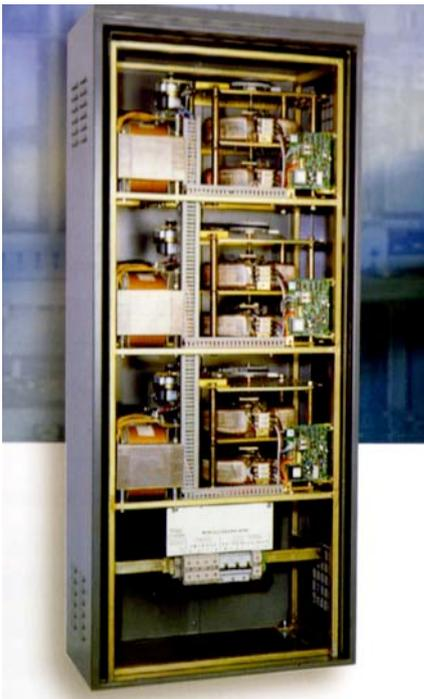
En la actualidad son equipos electrónicos estáticos, que actúan de forma independiente sobre cada una de las fases de la red, al objeto de estabilizar la tensión de cada una de éstas respecto al neutro común en el circuito de salida o utilización, y disminuir el nivel de dicha tensión a partir de la orden apropiada, para finalmente producir una reducción del flujo luminoso de la lámpara y el consiguiente ahorro energético.
